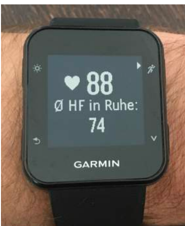
Abb. 5.2.9.1 Ant+ kompatible Watch mit Herzfrequenzmessung und Schrittzähler
